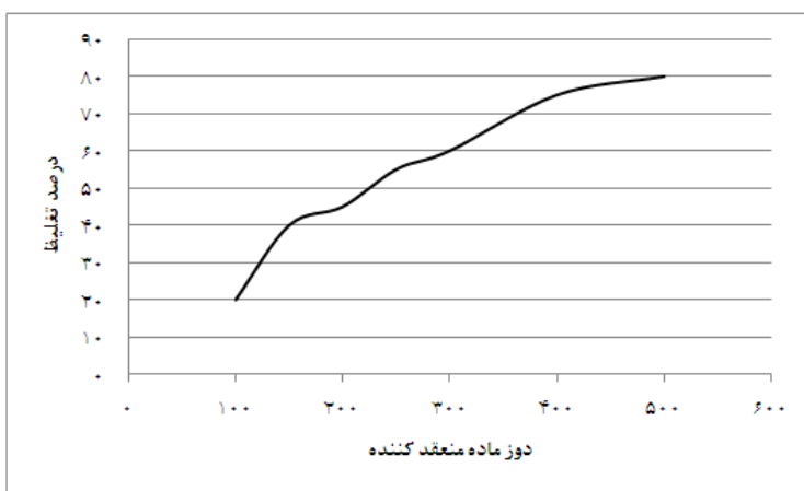
نمودار ۱: درصد تغلیظ لجن در غلظت‌های متفاوت سولفات آلومینیوم
