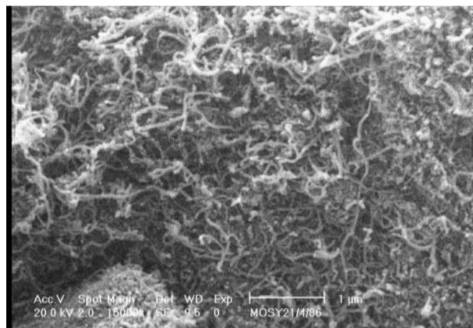
شکل ۱: شکل SEM نانوتیوب‌های کربنی چندجداره
