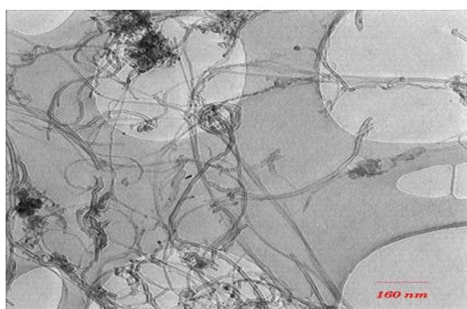
شکل ۲: شکل TEM نانوتیوب‌های کربنی چندجداره
