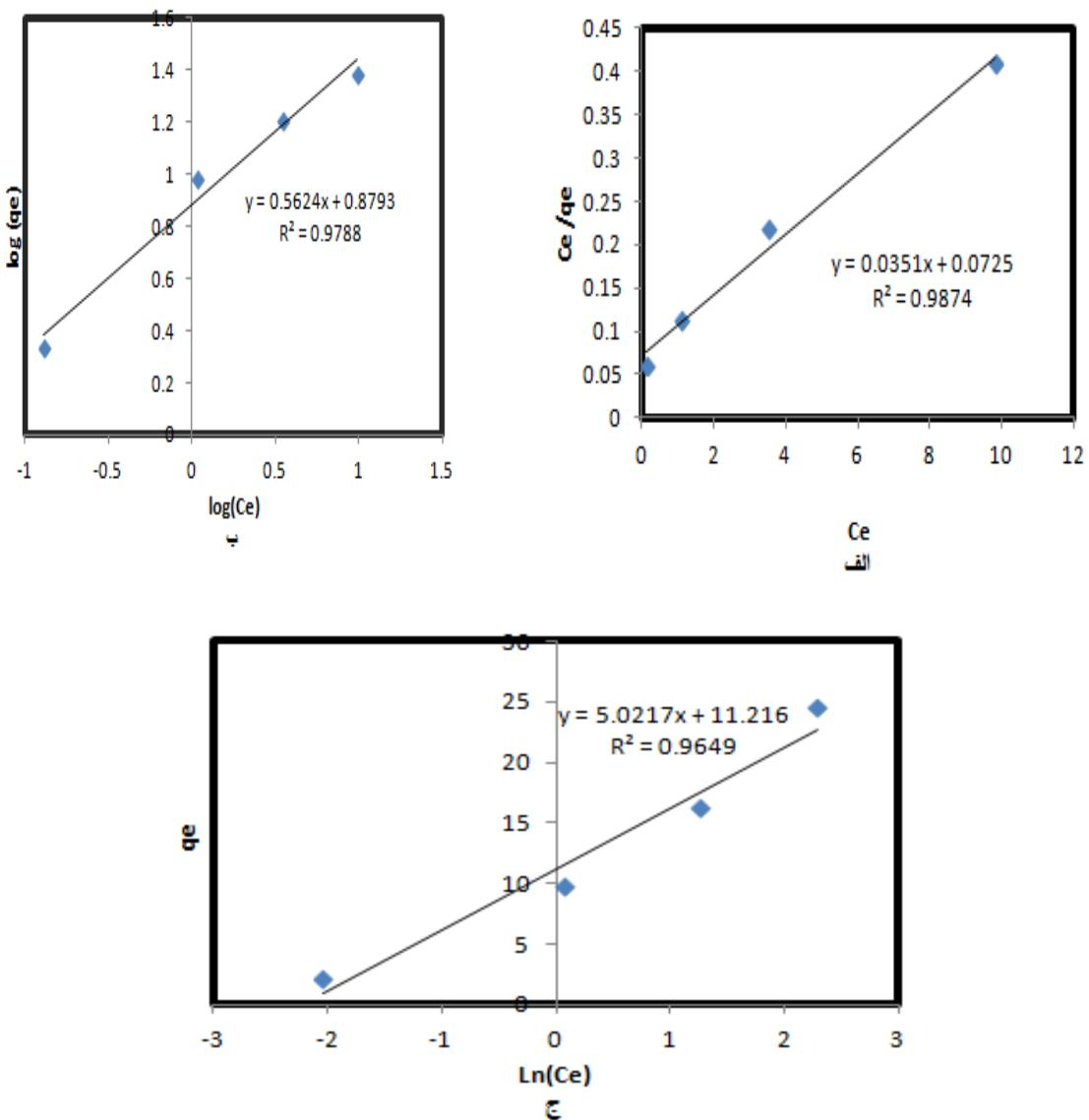
شکل ۶: مدل ایزوترمی (الف) لانگمویر، (ب) فرونولیخ، (ج) تمپکین برای جذب فسفر توسط نانولوله های کربنی چند دیواره
