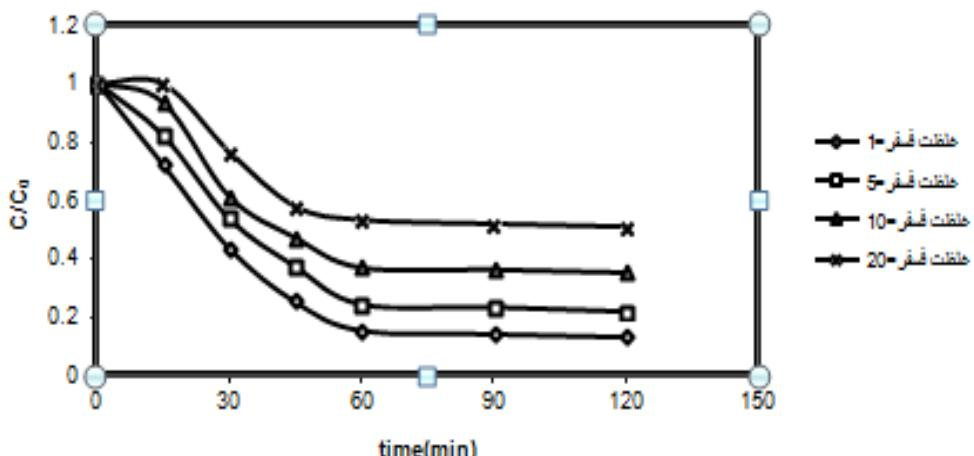
شکل ۵: تأثیر مقدار غلظت اولیه ماده فسفر معدنی بر روی حذف فسفر معدنی با استفاده از نانولوله‌های کربنی چند جداره در زمان  $120$  دقیقه مختلف،  $pH=7$  در دمای  $25^{\circ}C$  و غلظت  $1/4 \text{ mg/l}$  جاذب
