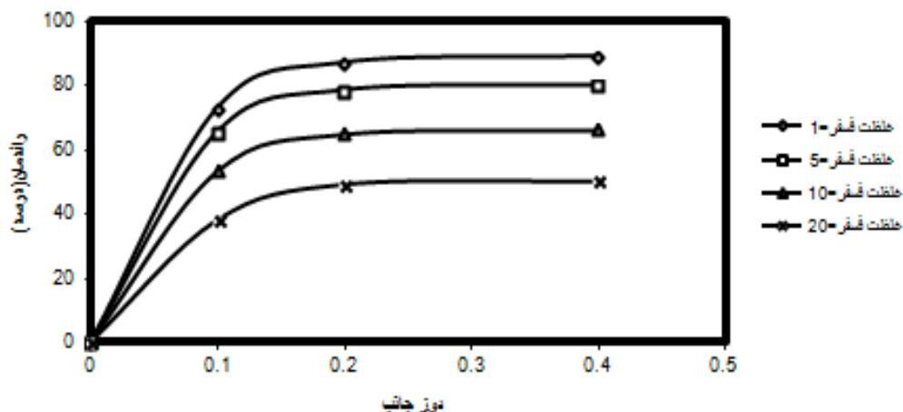
شکل ۴: تأثیر مقدار جاذب بر روی حذف فسفر معدنی با استفاده از نانولوله‌های کربنی چند جداره در زمان  $120$  دقیقه،  $pH=7$  در دمای  $25^{\circ}C$  در غلظت  $5\text{mg/l}$
