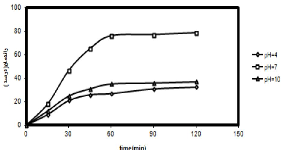
شکل ۳: تأثیر pH بر روی جذب فسفر با استفاده از نانولوله‌های کربنی چند جداره در زمان ۱۲۰، در دمای ۲۵°C، در غلظت ۵mg/L ماده فسفر و غلظت ۰/۰۲g/L جاذب
