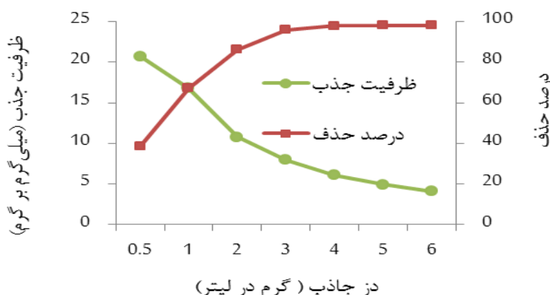
نمودار ۵: تاثیر دوز جاذب بر روی کارایی حذف (غلظت پیروکتکول ۲۵ میلی گرم در لیتر، زمان تماس ۹۰ دقیقه، pH=۳)
