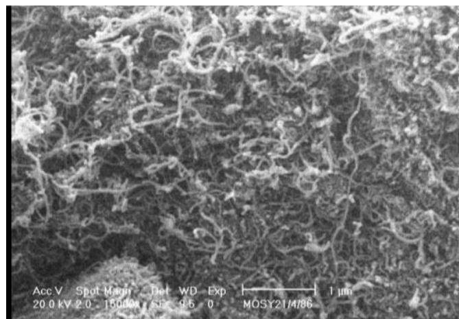
شکل ۱: شکل SEM نانوتیوب‌های کربنی چندجداره
