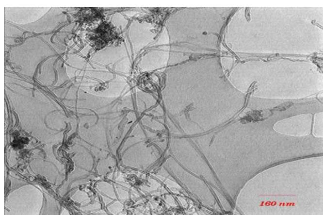
شکل ۲: شکل TEM نانوتیوب‌های کربنی چندجداره
